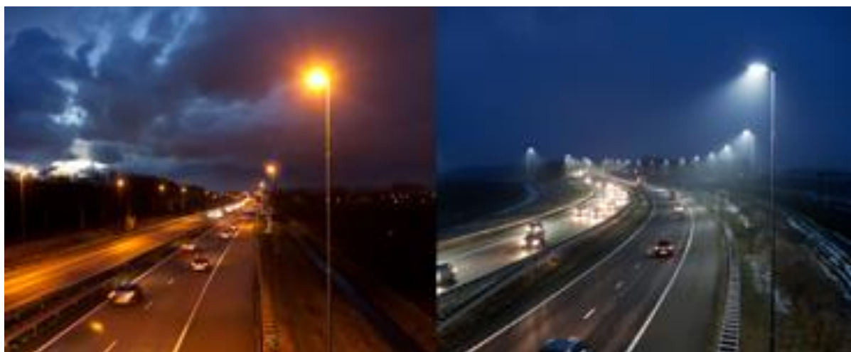
Afbeelding 1. Situatie met SON-SOX verlichting en met LED verlichting
